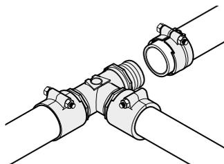
Зажимные фитинги Uronor Wipex предназначены для труб Thermo, Varia, Aqua, Quattro, Supra (Plus/Standard), используются в системах тепло- и холодоснабжения, холодного и горячего водоснабжения, канализации. Внутренняя резьба фитинга оснащена уплотнительным кольцом, не требуется уплотнение по резьбе. Для труб диаметром от 25 до 125 мм, серий S5,0 (PN6) и S3,2 (PN10).
