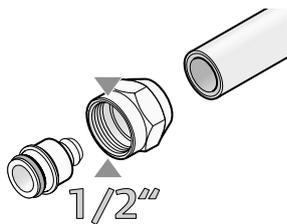
Фитинги и коллекторы Uni-C для подключения к трубам Uronor посредством зажимных адаптеров 1/2" для систем отопления, охлаждения и водоснабжения.
